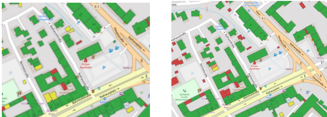
Abbildung 2 zur Solarenergienutzung des Rathauses Markt Garmisch-Partenkirchen. Dachpotential für Solarthermie links, für Photovoltaik rechts. Farbcode: Gut geeignet: Grüntöne ; nicht geeignet: Rot . (Quelle: Solarpotentialkataster des Landkreises Garmisch-Partenkirchen).
